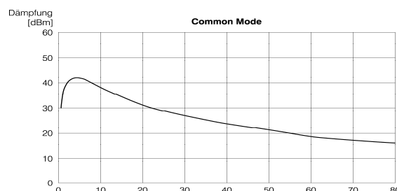
Bild 1: Dämpfungscharakteristik für symmetrische Störspannungen.
